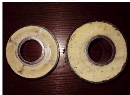
Fot. 15 Tradycyjna rura preizolowana niewspółosiowa w przekroju
