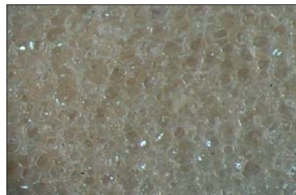
Fot. 1 Prawidłowa struktura pianki PUR (powiększenie pod mikroskopem)
