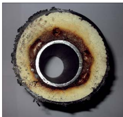
Fot. 6 Próbka po procesie przyspieszonego starzenia. Widoczny również brak współosiowości rury przewodowej i osłonowej
