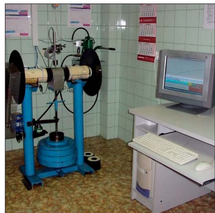
Fot. 5 Stanowisko do badań pękania
