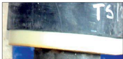
Fot. 4 Zespół rurowy po badaniu wytrzymałości na ścinanie osiowe. Pod wpływem siły przyłożonej do rury przewodowej izolacja wraz z rurą przewodową wysunęły się z rury osłonowej
