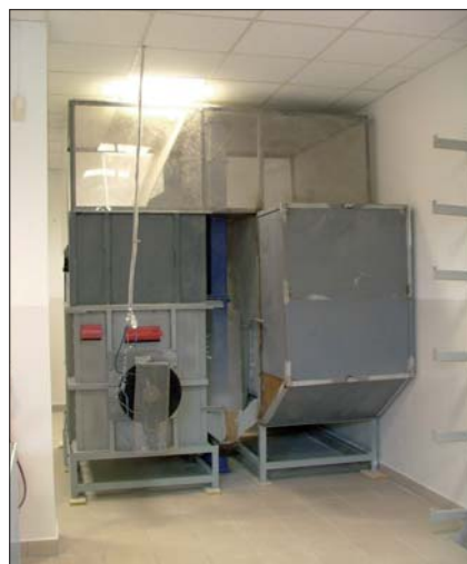
Fot. 7 Stanowisko obciążenia od gruntu „skrzynia z piaskiem”
