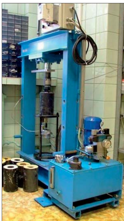
Fot. 3 Stanowisko do badania wytrzymałości na ścinanie osiowe
