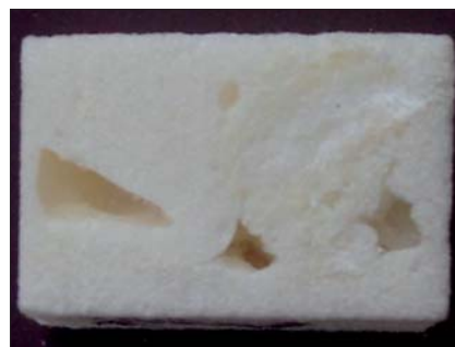
Fot. 2 Nieprawidłowa struktura pianki PUR (bez powiększenia)
