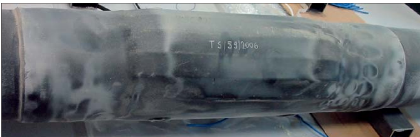
Fot. 14 Prawidłowo wykonana i szczelna nasuwka z usieczowanego HDPE
