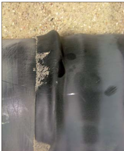
Fot. 9 Nasuwka z LD-PE odkształcona wskutek nieprawidłowo dobranej grubości wyrobu.
