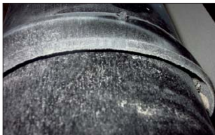
Fot. 10 Koniec mufy zgrzewanej elektrycznie po badaniu w skrzyni z piaskiem
