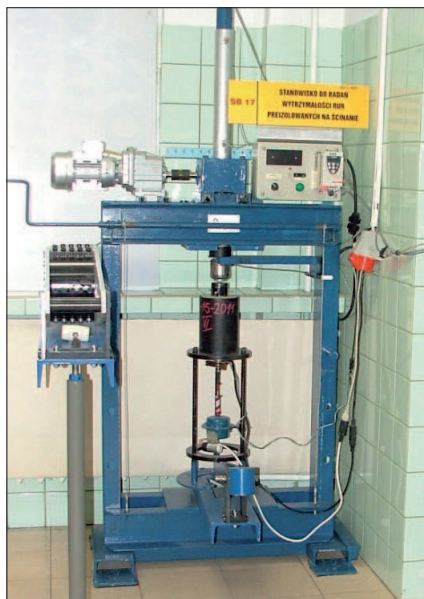
Fot. 3, 4 Stanowisko SB-17 do badań wytrzymałości na ścinanie
