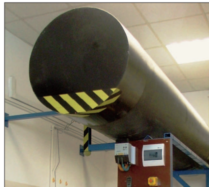
Fot. 2. Komora grzejna do starzenia próbek przed badaniem współczynnika przewodzenia ciepła
