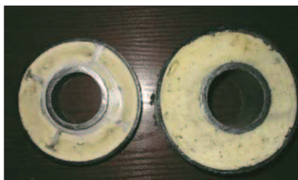
Fot. 6 Widok w przekroju niewspółosiowej rury preizolowanej
