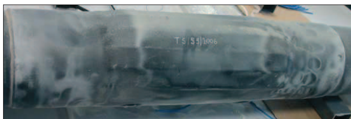
Fot. 5 Nasuwka z usieciowanego HDPE po badaniu obciążenia od gruntu 1000 cyklów – po badaniu nieprzepuszczalności wody była szczelna
