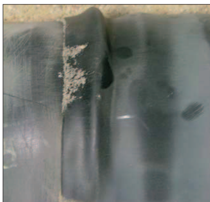
Fot. 1 Nasuwka z LD-PE po badaniu obciążenia od gruntu 200 cyklami – nasuwka odkształciła się wskutek nieprawidłowo dobranej grubości wyrobu, po badaniu nieprzepuszczalności wody była szczelna
