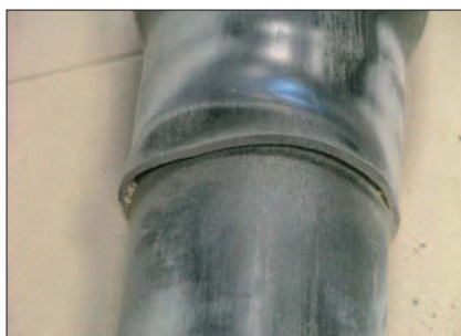
Fot. 3 Nasuwka z HDPE po badaniu obciążenia od gruntu 100 cyklów – nasuwka odkształciła się wskutek nieprawidłowo przeprowadzonego procesu obkurczania
