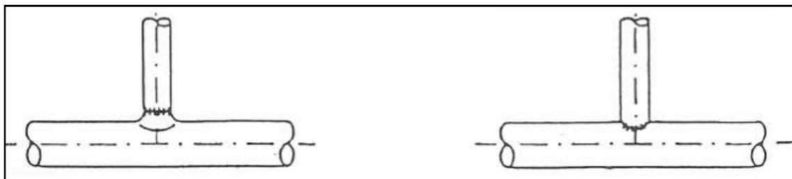
Rys. III 8.3.4 Trójnik spawany z wyciąganą szyjką (z lewej strony) oraz trójnik spawany bezpośrednio bez nakładki wzmacniającej (z prawej strony)
